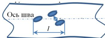
При расшифровке снимков размеры дефектов до 3,0 мм следует округлять в большую сторону с дискретностью 0,1 мм, при размерах дефектов более 3,0 мм округление производят с дискретностью 0,5 мм.
