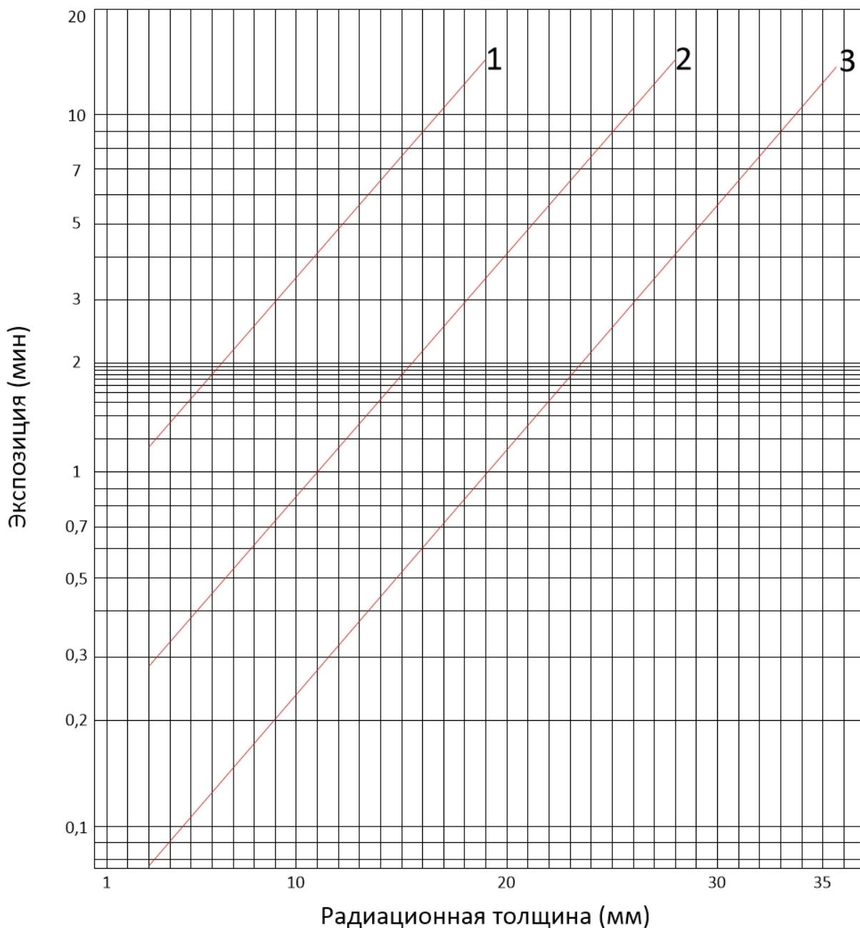
При расчете времени просвечивания по номограмме для Р-аппаратов постоянного действия полученную экспозицию ( $\text{mA} \cdot \text{мин}$ ) следует разделить на значение максимального тока, определяемого из таблицы 2, при этом искомое время просвечивания следует выражать в секундах. Данные номограммы позволяют рассчитать время экспозиции при просвечивании стали и при использовании рентгеновской пленки Agfa D7 с относительным экспозиционным фактором равным 1.
