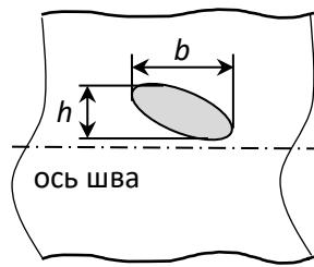
Если проекции протяженных дефектов (непроваров и трещин) на ось шва накладываются друг на друга, то в качестве протяженности принимается общая проекция на ось шва.
