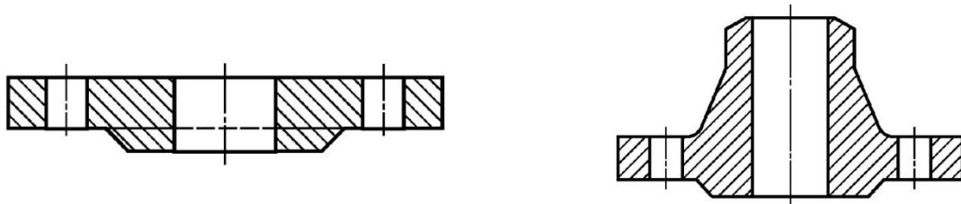
Тип 01-Фланец стальной плоский приварной Тип 11-Фланец стальной приварной встык
